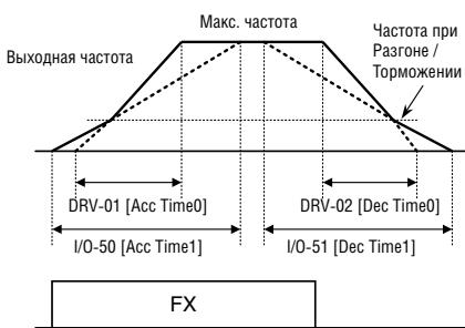
[Регулирование изменений при разгоне/торможении]
