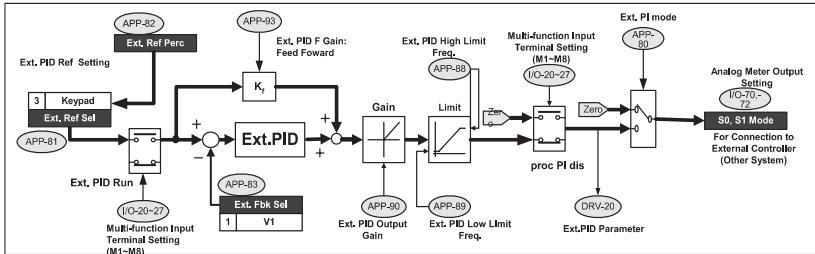
Это показывает независимое осуществление контроля за другой системой. Установите I/O-70 или 72 [S0/S1 mode] в положение “Ext PID Out” и подсоедините внешнюю систему к входам S0 или S1. При подаче сигнала внешнего ПИД-регулирования на обозначенный вход I/O-20-27, он начинает выводить сигнал.
