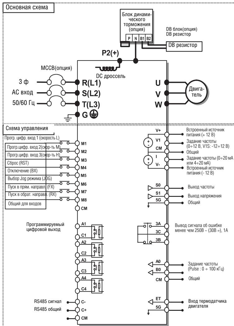
Примечание: 1) 5G общая земля для выхода аналогового прибора (S0, S1) и для внешнего определения температуры двигателя.
