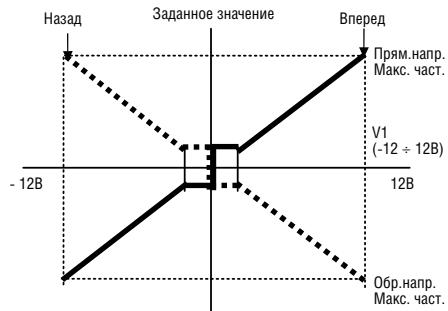
Для запуска двигателя в прямом направлении нажмите кнопку FWD и примените напряжение  $0 \div 12$  В, как задание частоты, или нажмите кнопку REV и примените напряжение  $-12 \div 0$  В, как задание частоты. Для запуска двигателя в обратном направлении нажмите FWD и примените напряжение  $-12 \div 0$  В, или нажмите REV и примените  $0 \div 12$  В.
