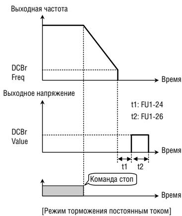
**Примечание:** Не устанавливать FU1-27 свыше номинального тока частотного преобразователя. В противном случае, может возникнуть сбой из-за перегрева двигателя или перегрузки.
