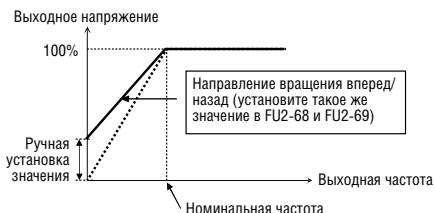
[Момент нагрузки не зависит от направления: конвейер и т.д.]
