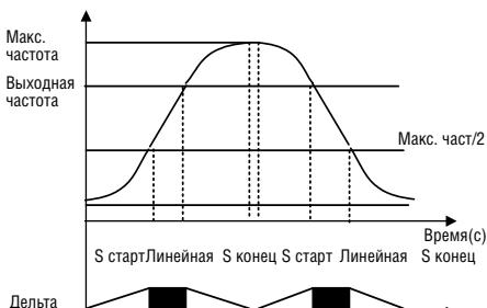
[Характеристика разгона/торможения: 'S-тип']
