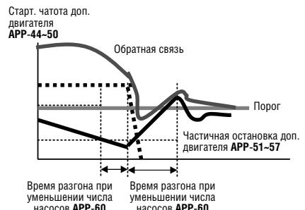
Дополнительные двигатели открыты при значении вращения основного двигателя ниже, установленного в APP-51~57 [Aux motor stopping frequency] в течение времени выше значения, установленного в APP-59 [Aux motor stopping delay time], и значение отклонения давления между опорной частотой ПИД регулирования и значением обратной связи превышает установленное в APP-71 [Aux motor starting /stopping pressure difference] значение.
