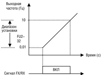
**Примечание:** Двигатель начнет вращение при 5 Гц, если FU2-32 установлен на 5 Гц.
