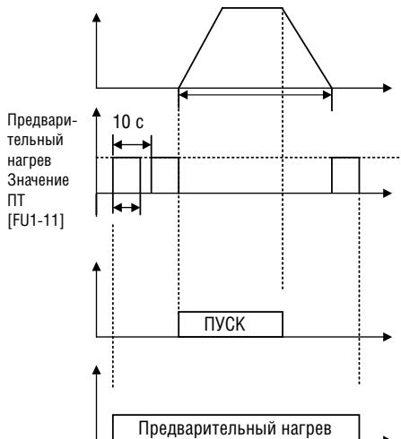
Функция предварительного нагрева активируется, когда FU1-10 [Pre-heat] установлен в положение "Yes", а одна из клемм цифрового ввода в I/O-20~27 установлена в "Pre-heat" и заданная клемма в положении ON активируется только при остановке преобразователя.
