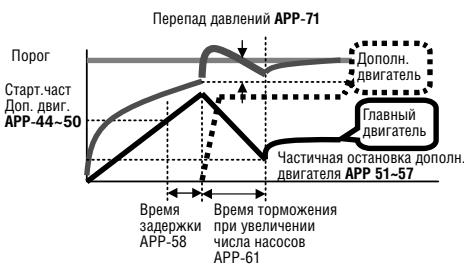
**Условие активной работы дополнительных двигателей:** скорость главного двигателя превышает стартовую частоту дополнительного двигателя (APP-44~50), в течении времени APP-58 [Aux motor starting delay time], отклонение между опорным значением ПИД и значением обратной связи превышает установленное в APP-71 [Starting Aux motor pressure difference].
