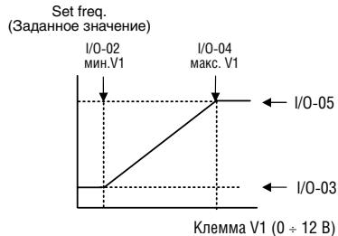
Установки для двух-полярности и однополярности такие же, как на выше приведенном графике. Установите положительное значение для напряжения и частоты, а отрицательное будет симметрично положительному. Следующий график показывает отношение входного напряжения и задания направления (положительное/отрицательное).
