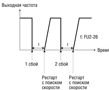
**Примечание:** Преобразователь уменьшает количество попыток перезапуска на единицу после каждого перезапуска. Если после перезапуска преобразователь проработал более 30 секунд, количество попыток увеличивается на единицу, но ограничено значением, заданным в FU2-25.
